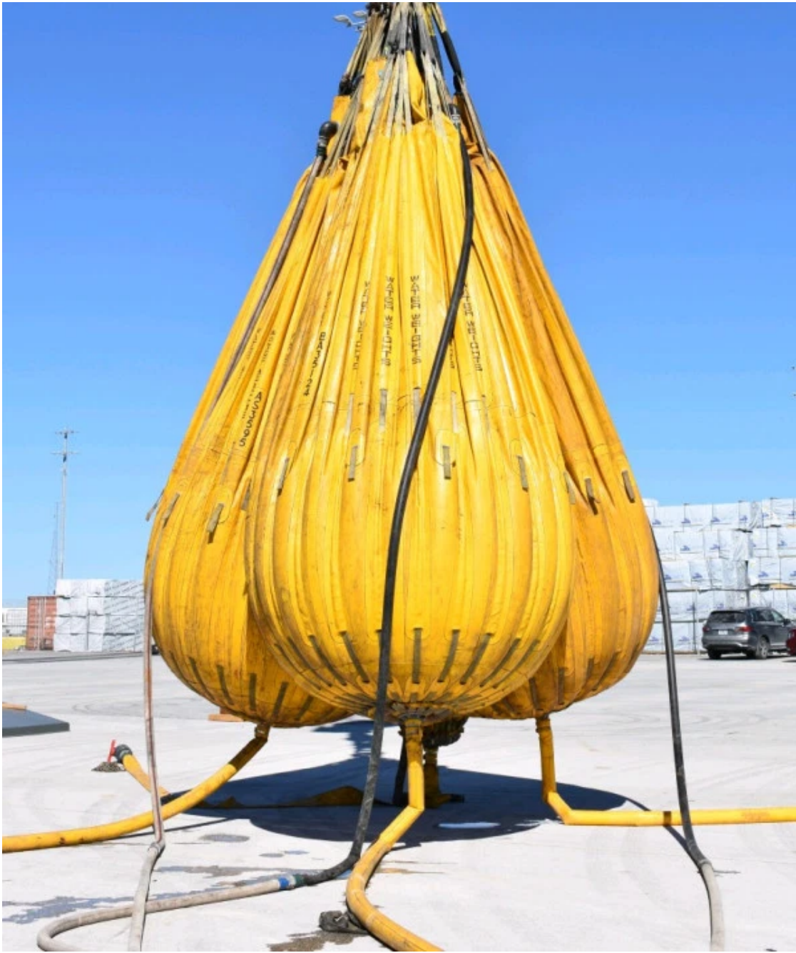
2 – Bolsas de agua para la prueba de carga.
