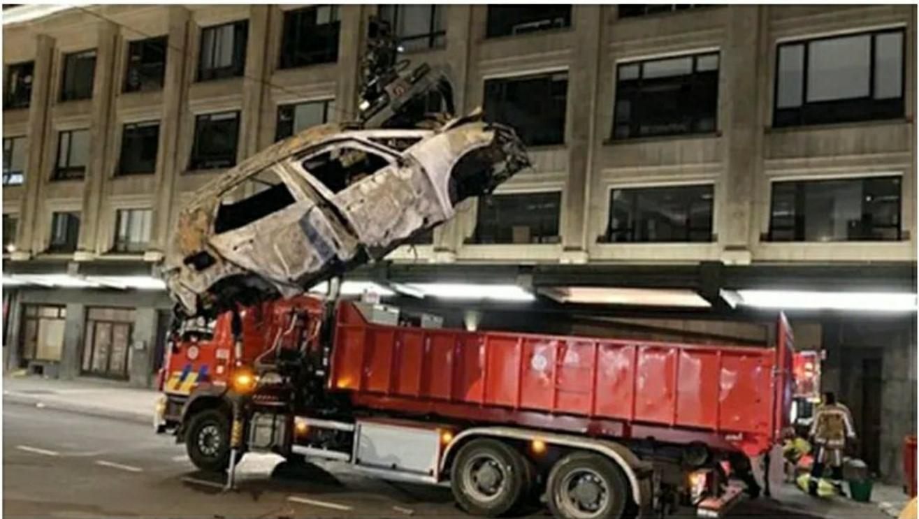
Un segundo VW ID3 entró en 'embalamiento térmico' (thermal runaway) en un estacionamiento subterráneo en Bruselas el mes pasado. No estaba cargando sus baterías. Los equipos de bomberos no sabían inicialmente que estaban tratando con un EV -vehículo eléctrico-, pero usaron un contenedor de agua para sumergirlo una vez que lo tuvieron a nivel del suelo. Imagen cortesía de @pompier
