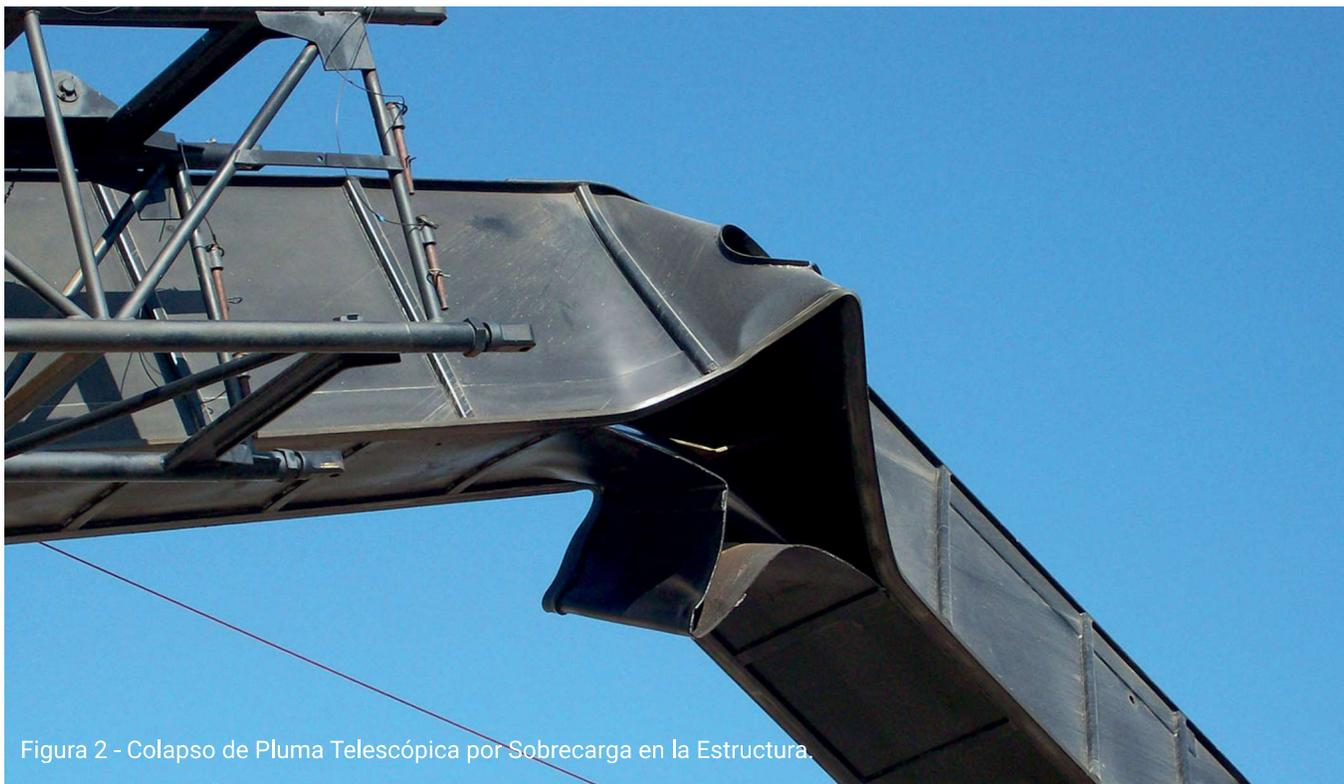
Figura 2 - Colapso de Pluma Telescópica por Sobrecarga en la Estructura.
