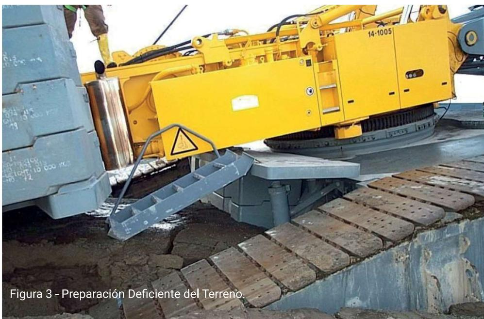
Figura 3 - Preparación Deficiente del Terreno.
